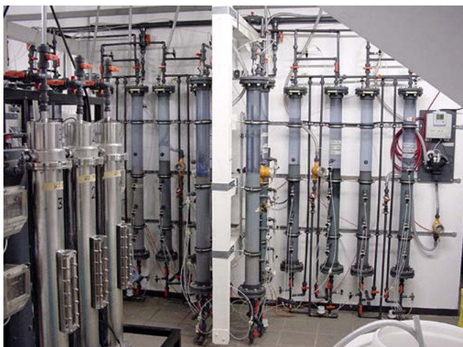
Abb. 3: IWW-Versuchsanlagen zur Schwermetallentfernung mit selektiven Ionenaustauschern
