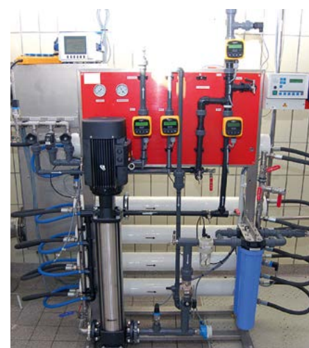
Abb. 5: IWW-Versuchsanlage zur Enthärtung / Entsalzung mittels Umkehrosmose / Nanofiltration
