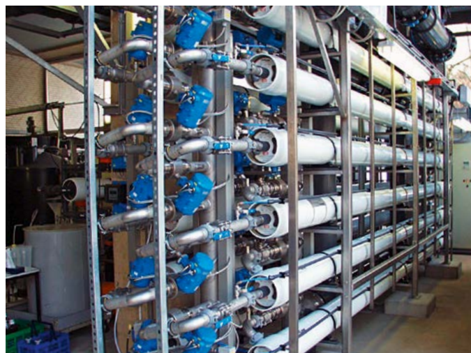
Abb. 4: Versuchsanlage zur Partikeleliminierung mittels Ultrafiltration
